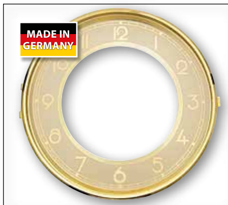
Lunette Gepolijste, messingkleurig aluminium met gedrukte champagnekleurige ringzone en uitgespaarde cijfers. Gebold scharnierglasdeksel met diamantgesneden messing ring. Buiten-Ø 160 mm, binnen-Ø 96 mm. Binnenwerkse hoogte ca. 18 mm. Voor wijzerlengte 60-70 mm. 326039 99,00
