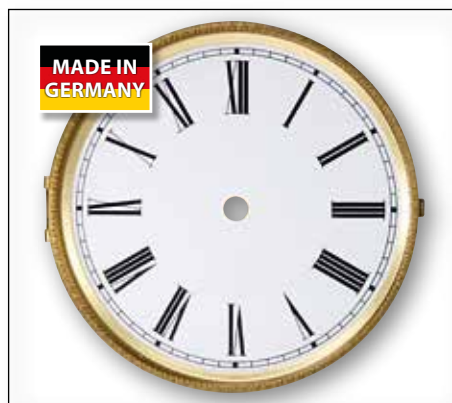
Lunette voor wand- en tafelklokken Wit emaille wijzerplaat, glazen scharnierdeksel met gepatineerde messingrand en gebold glas. Buiten-Ø 160 mm. Middengat-Ø 10,2 mm. Binnenwerkse hoogte ca. 16 mm. Voor wijzerlengte 58-65 mm. 334948 129,00
