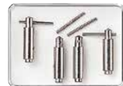
Pfeiler für Regulateur-Zifferblätter Ø 5 mm, Ø 3,5-mm-Ansätze, Querbohrung für Vorsteckstift. Packung mit 4 Pfeilern einschl. Vorsteckstiften.
